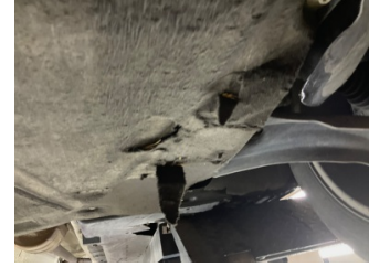
Motor, Alt muhafaza > Hasarlı
