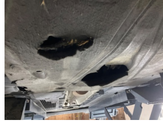
Motor, Alt muhafaza > Hasarlı
