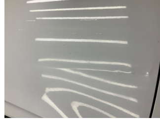
Kapı, sağ ön, Kapı, sağ ön > Hasarlı
