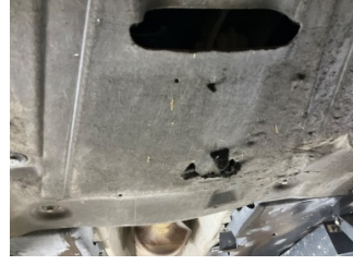
Motor, Alt muhafaza > Hasarlı
