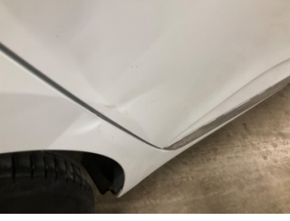
Kapı, sağ arka, Kapı, sağ arka > Ezik
