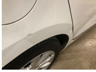
Çamurluk, sağ arka, Çamurluk, sağ arka > Ezik
