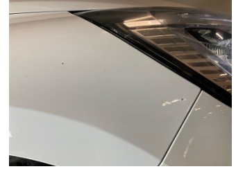
Çamurluk, sağ, Çamurluk, sağ > Taş Izi
