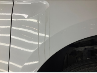
Çamurluk, sağ, Çamurluk, sağ > Yakıcı Madde Ile Zarar Görmüş
