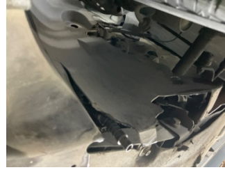
Çamurluk, sol, Davlumbaz > Hasarlı
