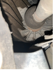
Şanzıman, Şanzıman > Yağ Kaçağı
