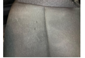
Döşemeler/Kapaklar, Döşemeler/Kapaklar > Yakıcı Madde İle Zarar Görmüş
