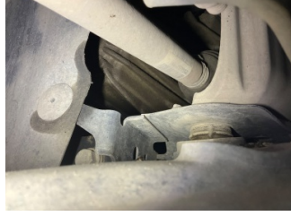
Şanzıman, Şanzıman > Yağ Kaçağı
