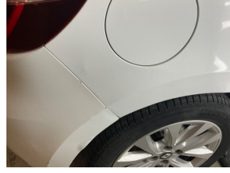
Çamurluk, sağ arka, Çamurluk, sağ arka > Ezik
