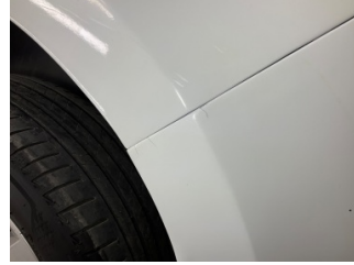
Tampon, arka, Arka tampon > Boyası Atmış
