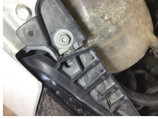
Farlar, Far bağlantı ayağı, sağ > Hasarlı
