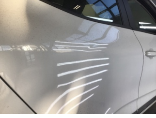
Kapı, sağ arka, Kapı, sağ arka > Ezik
