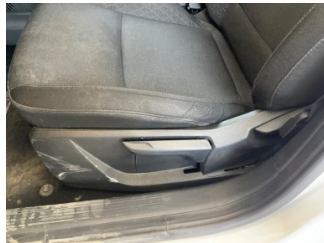
Döşemeler/Kapaklar, Döşemeler/Kapaklar > Deforme Olmuş
