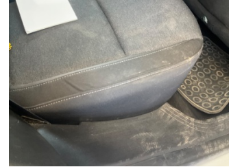
Döşemeler/Kapaklar, Döşemeler/Kapaklar > Deforme Olmuş
