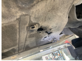
Motor, Alt muhafaza > Hasarlı
