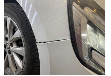
Tampon, ön, Ön tampon > Sabitlemesi Hatalı
