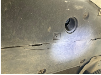
Tampon, ön, Tampon koruyucu orta > Hasarlı
