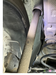
Arka aks, Amortisör, arka sol > Yağ Kaçağı
