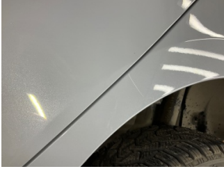
Çamurluk, sol, Çamurluk, sol > Küçük Çizik
