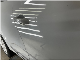
Kapı, sağ ön, Kapı, sağ ön > Vuruk
