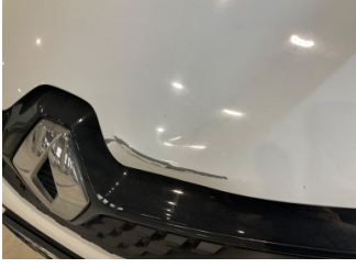
Motor kaputu, Motor kaputu > Hasarlı
