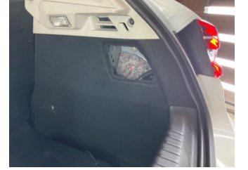
Döşemeler/Kapaklar, Bagaj bölümü döşemesi > Eksik
