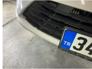
Tampon, ön, Ön tampon ızgarası > Sabitlemesi Hatalı
