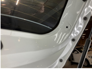
Döşemeler/Kapaklar, Bagaj bölümü döşemesi > Eksik
