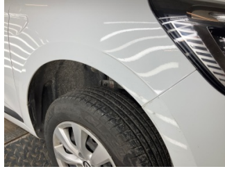
Çamurluk, sağ, Çamurluk, sağ > Yüzeysel Çizik
