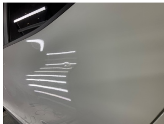
Kapı, sol arka, Kapı, sol arka > Vuruk
