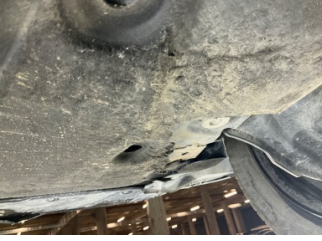
Motor, Alt muhafaza > Hasarlı
