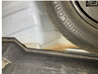
Arka bölüm, Arka sac/panel > Hasarlı
