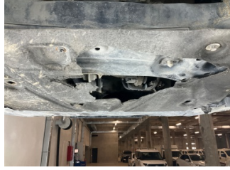
Motor, Alt muhafaza > Hasarlı
