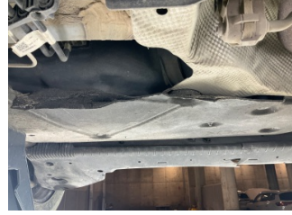
Kaporta, Muhafaza, arka > Hasarlı
