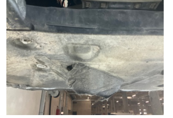
Motor, Alt muhafaza > Hasarlı
