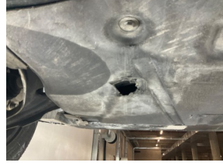
Motor, Alt muhafaza > Hasarlı
