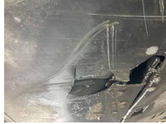
Motor, Alt muhafaza > Hasarlı
