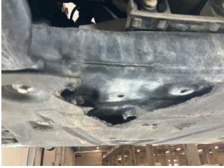
Motor, Alt muhafaza > Hasarlı
