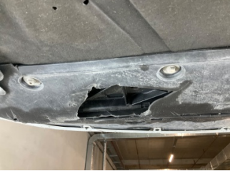
Tampon, ön, Tampon koruyucu orta > Hasarlı
