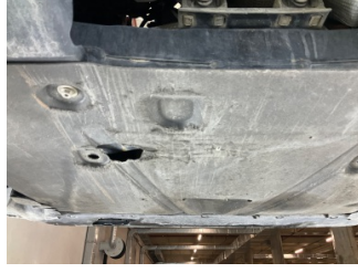
Motor, Alt muhafaza > Hasarlı
