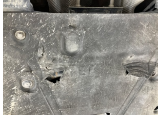
Motor, Alt muhafaza > Hasarlı
