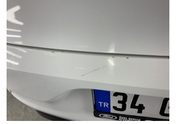
Tampon, arka, Arka tampon > Küçük Çizik
