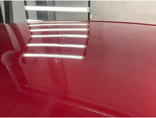
Tavan, Tavan > Dolu Hasarı
