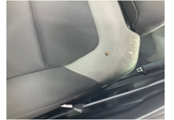
Döşemeler/Kapaklar, Döşemeler/Kapaklar > Yakıcı Madde Ile Zarar Görmüş
