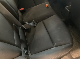
Döşemeler/Kapaklar, Döşemeler/Kapaklar > Kirlenmiş
