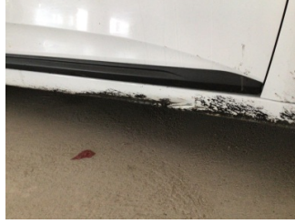
Marşbiyel, sağ, Marşbiyel, sağ > Hasarlı
