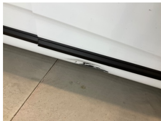
Marşbiyel, sağ, Marşbiyel, sağ > Hasarlı
