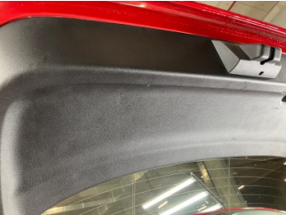
Döşemeler/Kapaklar, Döşemeler/Kapaklar > Çizik
