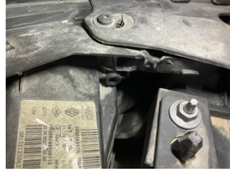
Farlar, Far camı, sol > Standart Dışı Onarım
