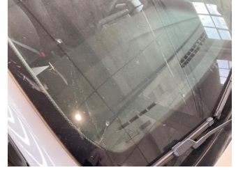
Camlar, Ön cam > Hasarlı
