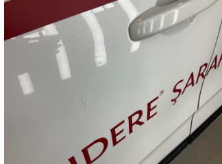
Kapı, sol ön, Kapı, sol > Noktasal Ezik
