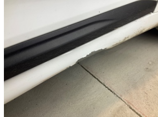
Marşbiyel, sağ, Marşbiyel, sağ > Hasarlı
