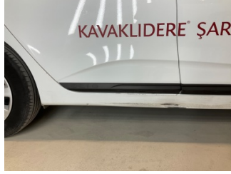
Kapı, sağ arka, Kapı bandı > Hasarlı
