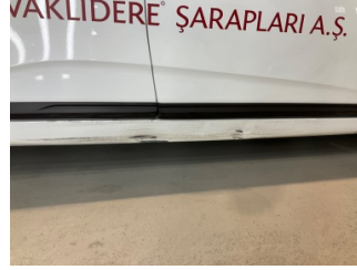
Marşbiyel, sağ, Marşbiyel, sağ > Hasarlı
