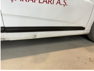
Kapı, sağ ön, Kapı bandı > Hasarlı
