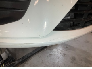
Tampon, ön, Ön tampon > Çatlak
