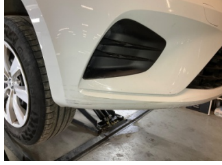
Tampon, ön, Ön tampon > Çatlak
