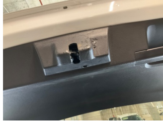
Döşemeler/Kapaklar, Bagaj kapağı, iç döşemesi > Çizik
