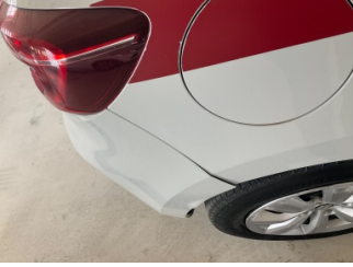
Tampon, arka, Arka tampon > Sabitlemesi Hatalı
