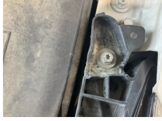
Farlar, Far bağılantı ayağı, sol > Standart Dış Onarım
