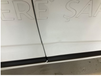
Kapı, sağ ön, Kapı, sağ > Hasarlı
