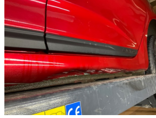
Marşbiyel, sol, Marşbiyel, sol > Hasarlı
