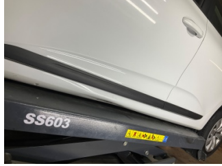
Marşbiyel, sol, Marşbiyel, sol > Hasarlı
