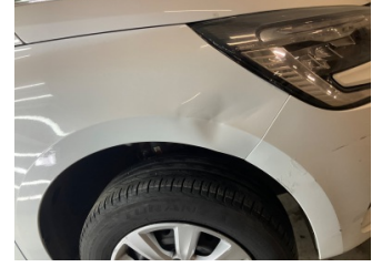
Çamurluk, sağ, Çamurluk, sağ > Hasarlı
