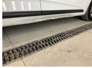
Marşbiyel, sağ, Marşbiyel, sağ > Hasarlı
