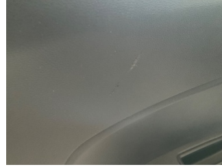
Döşemeler/Kapaklar, Kapı döşemesi, sol arka > Çizik
