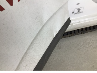
Kapı, sağ arka, Kapı, sağ arka > Ezik
