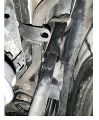
Arka aks, Amortisör, arka sağ > Yağ Kaçağı
