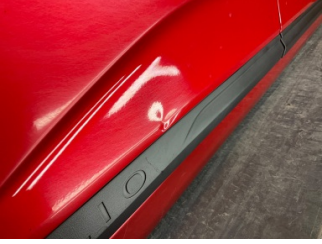
Kapı, sağ arka, Kapı, sağ arka > Ezik
