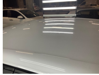
Tavan, Tavan > Dolu Hasarı
