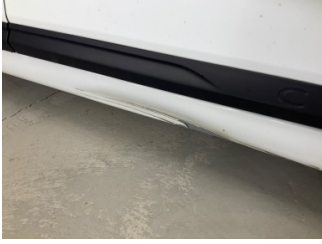
Marşbiyel, sol, Marşbiyel, sol > Hasarlı
