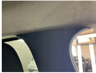
Döşemeler/Kapaklar, Döşemeler/Kapaklar > Kirlenmiş
