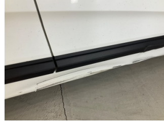
Marşbiyel, sağ, Marşbiyel, sağ > Hasarlı
