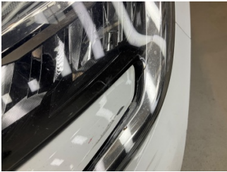
Farlar, Far camı, sol > Hasarlı
