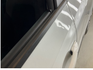
Kapı, sol ön, Kapı, sol > Noktasal Ezik
