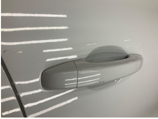
Kapı, sağ ön, Kapı kolu, dış > Çizik
