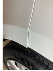
Tampon, arka, Arka tampon > Sabitlemesi Hatalı
