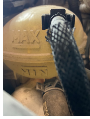
Motorsoğutması, Soğutma sıvısı > Eksik
