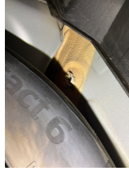
Arka bölüm, Bagaj havuzu > Hasarlı
