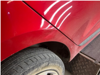
Çamurluk, sağ arka, Çamurluk, sağ arka > Ezik
