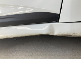
Marşbiyel, sağ, Marşbiyel, sağ > Hasarlı
