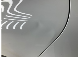
Kapı, sol arka, Kapı, sol arka > Hasarlı
