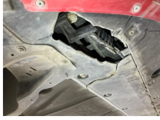
Tampon, ön, Tampon koruyucu orta > Hasarlı
