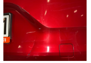
Tampon, arka, Arka tampon > Çatlak
